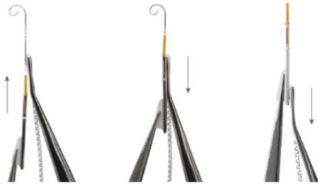
Procedura rigenerazione elettrodo
